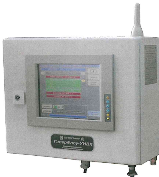
Рисунок 1 - Коммуникатор в металлическом шкафу
